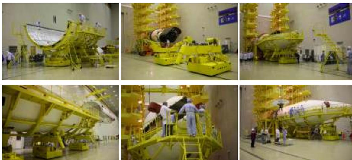
Processo de «encapsulamento» ou de colocação do satélite Anik-G1 juntamente com o estágio superior Briz-M no interior da carenagem de protecção. Imagens: GKNPTs Khrunichev
