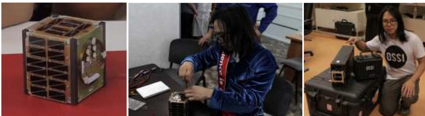
Desenvolvido pela empresa *Cosmogia Inc.*, o nano-satélite Dove-2 constitui uma missão de demonstração tecnológica para propósitos de detecção remota. Tendo por base o modelo CubeSat-3U e com uma massa de 3,8 kg no lançamento, o Dove-2 tem também como objectivo o teste das capacidades de um satélite de baixo custo limitado pelos constrangimentos do modelo CubeSat-3U e que seja capaz de transportar uma pequena carga.
