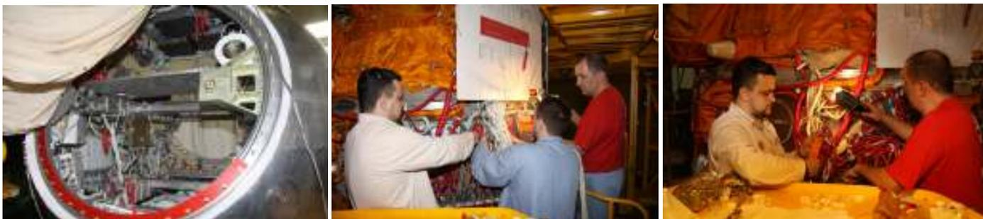
No dia 27 de Fevereiro<sup>10</sup> procedeu-se à junção entre o módulo de descida e o módulo de serviço. Estes dois módulos haviam sido transportados em separado para o cosmódromo, tendo sido submetidos a testes individuais. Finalizados estes testes, procedeu-se à junção dos dois módulos e deu-se início aos testes integrados entre as duas secções.
