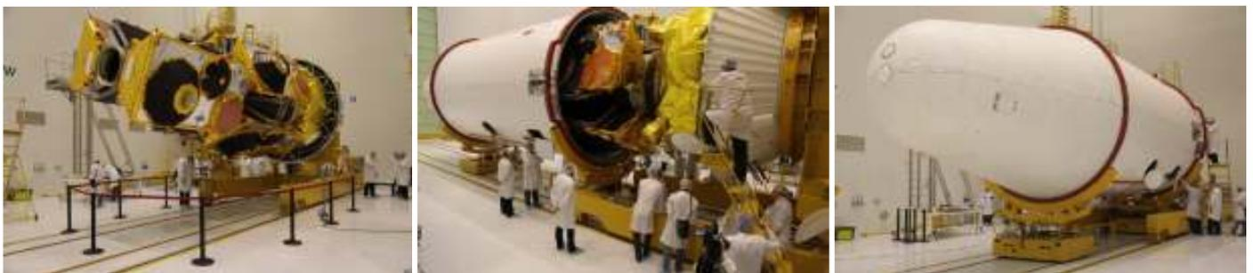
Com os satélites no interior da carenagem de protecção, e constituído assim a Unidade Orbital, esta foi transportada desde o MIK 112 para o MIK 40 da Área 31 onde se procedeu ao processamento e preparação do foguetão 14A14-1A Soyuz-2-1A (И15000-011) para o lançamento.
