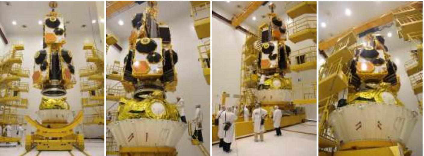
**A colocação do sistema de transporte com os seis satélites Globalstar-2 sobre o estágio Fregat-M. Imagens. TsENKI.**
