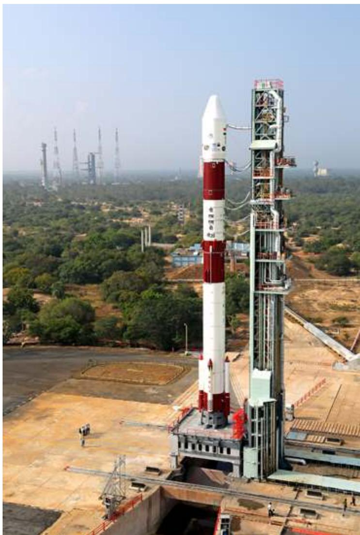
a quatro estágios, sendo o segundo e o quarto estágios a combustível líquido e os restantes a combustível sólido. O PSLV é capaz de colocar 3.700 kg numa órbita terrestre baixa a 200 km de altitude com uma inclinação de 49,5° em relação ao equador terrestre ou então 800 kg numa órbita de transferência para a órbita geossíncrona.
