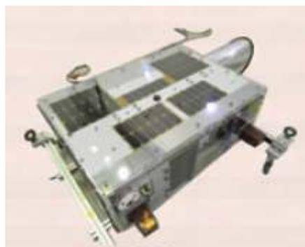
O *Near-Earth Object Space Surveillance Satellite* (NEOSSat) foi construído pela *Microsat Systems Canada Inc* (MSCI). O satellite está equipado com um telescópio espacial dedicado à detecção e seguimento de asteróides e satélites na órbita geostacionária. No lançamento o satélite tinha uma massa de 74 kg.
