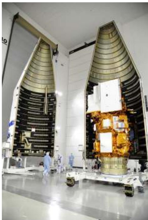
A estrutura de transporte dos instrumentos do LDCM fornece energia, controlo da altitude e da órbita, comunicações e armazenamento de dados para o OLI e para o TIRS. O satélite consiste do subsistema mecânico (estrutura primária e mecanismos amovíveis), subsistema de comando e tratamento de dados, subsistema de controlo de atitude, subsistema de energia eléctrica, subsistema de comunicações por rádio frequência, subsistema de propulsão por hidrazina e subsistema de controlo térmico.
