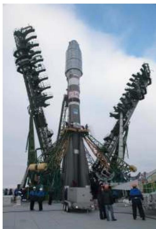
Após ser colocado na plataforma de lançamento, iniciam-se dois dias de preparativos para a missão. A contagem decrescente final para o lançamento tem início a T-10 horas, ocorrendo também o início da verificação dos sistemas do foguetão lançador. A T-5h dá-se a verificação dos sistemas do estágio superior Fregat-M. A T-4h 20m tem lugar a reunião da Comissão Técnica que autorizou o abastecimento do lançador que entretanto tem início a T-4h. A remoção das plataformas de serviço ocorre a T-30m.
