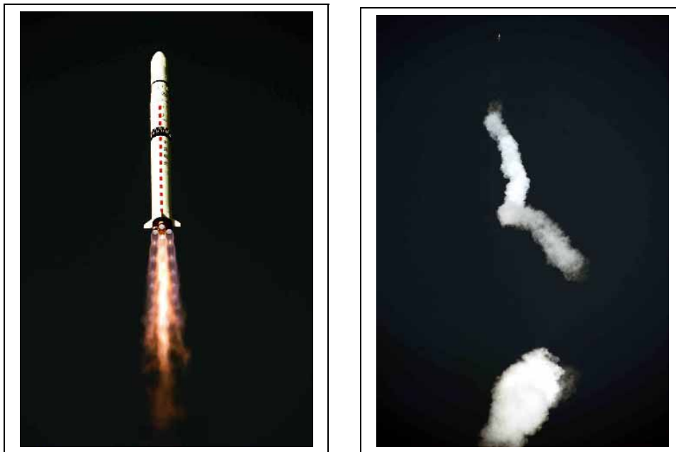
Na imagem à esquerda é possível observar a queima do primeiro estágio do CZ-4B Chang Zheng-4B/2. Na imagem em cima observa-se a separação entre o primeiro e o segundo estágio. Imagens: Agência Xinhua.
