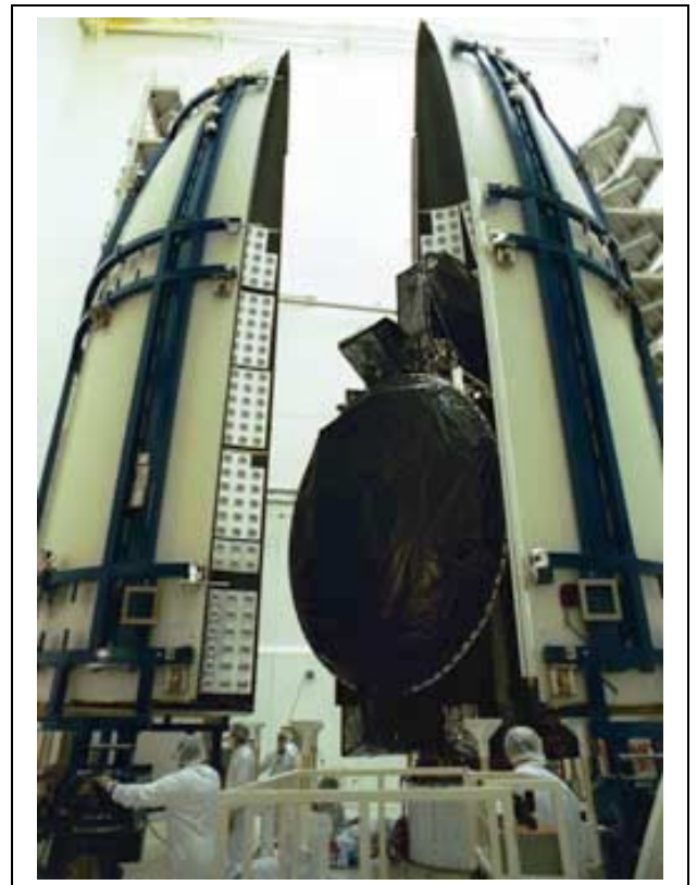
Colocação do satélite de comunicações Rainbow-1 no interior da ogiva de protecção do foguetão lançador Atlas-5/521. Imagem: Lockheed Martin .
