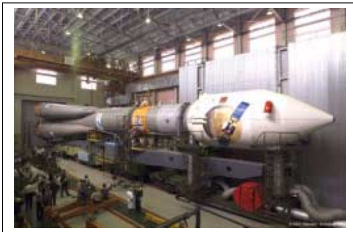
O foguetão lançador 11A511U-FG Soyuz-FG Fregat no interior do edifício de integração e montagem no Cosmódromo GIK-5 Baikonur antes de ser transportado para a plataforma de lançamento. Imagem: Rosaviakosmos.
