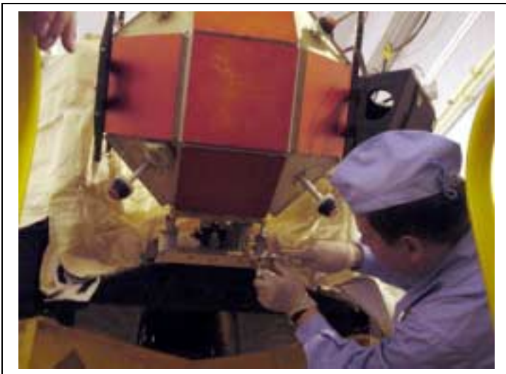
Técnicos colocam o satélite MIMOSA no sistema de separação do lançador. Os painéis solares do satélite ainda estão protegidos por coberturas. Imagem: Eurockot Launch Services .
