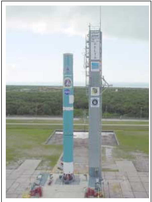
O primeiro e o segundo estágio do foguetão Delta-2 7425-9.5 na plataforma de lançamento SLC-17A do Cabo Canaveral, aguardam a chegada dos quatro propulsores laterais de combustível sólido que serão acoplados na parte inferior do primeiro estágio. Imagem: Boeing.
