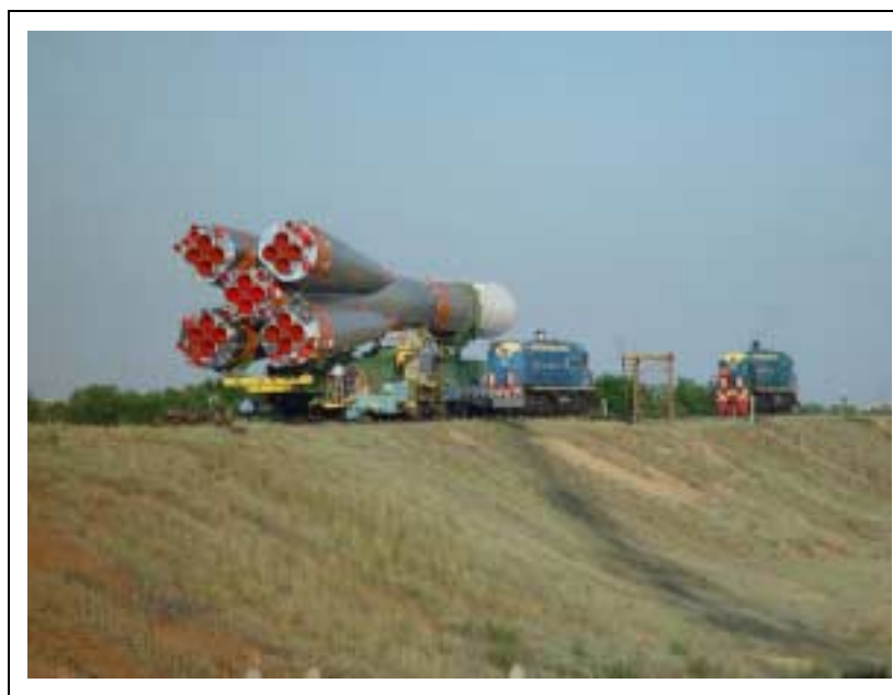
O lançador 11A511U Soyuz-U é transportado para a plataforma de lançamento em Baikonur, tendo já no seu topo o cargueiro 11F615A55 7K-TGM n.º 246 com destino à ISS. Imagem: RCS Energiya.
