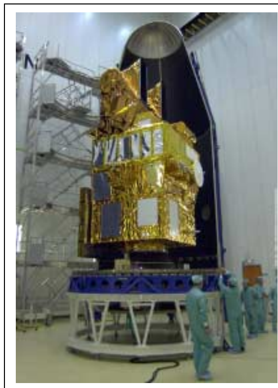
25 de Abril de 2002 – O satélite SPOT-5 é colocado no interior da ogiva de protecção do foguetão Ariane 42P. Imagem: Arianespace.
