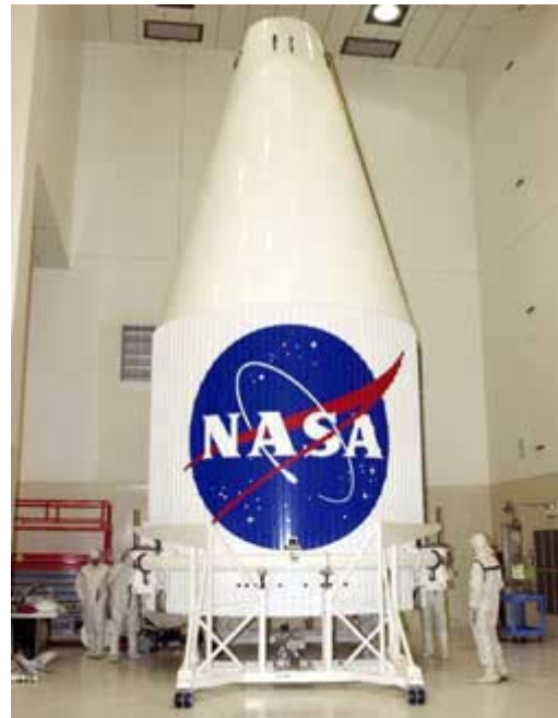
Ogiva do Atlas-2A que albergaria o TDRS-I, protegendo-o na fase inicial do lançamento. Imagem: NASA.
