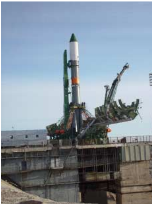
(À Direita) 19 de Março de 2002. Após ser colocado na posição vertical, as estrutura de serviço envolvem o lançador para permitir os acessos às suas diversas áreas. Imagem: RKK Energiya.
