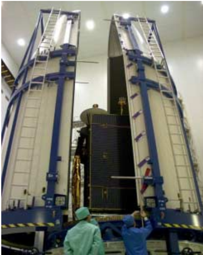
O satélite indiano Insat-3C é colocado no interior da ogiva de protecção do lançador Ariane-42L. Imagem Arianespace.
